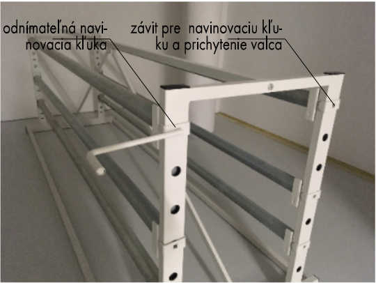
ukážka uchytenia a ovládania valca
